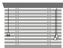
No Standard (D) Inclinador a la derecha, freno a la izquierda
