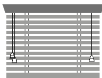
Standard (B) Inclinador a la izquierda, freno a la derecha
